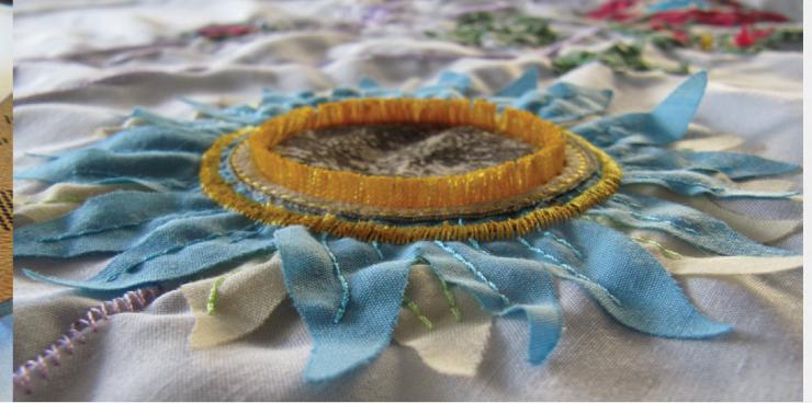
Thanks to a friendly interface software it becomes easy to find the proper power and speed to cut one layer of fabric avoiding to touch that below. Grazie ad una interfaccia utente estremamente intuitiva diventa facile scegliere la giusta potenza e velocità raggio laser per tagliare il primo strato di tessuto lasciando intatto quello sottostante.
